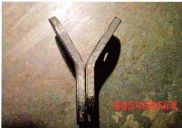
链条压弯的要求标准 Plate bending standard
