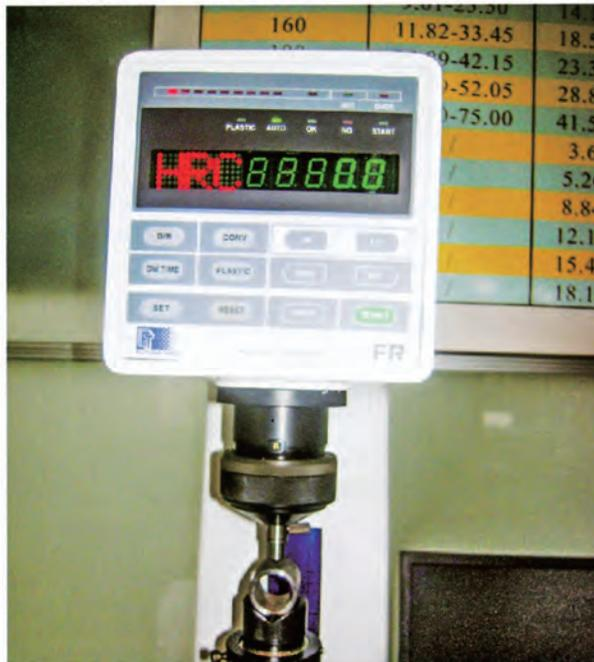
自动记录布洛维硬度机 Auto recording Brinell hardness gauge
