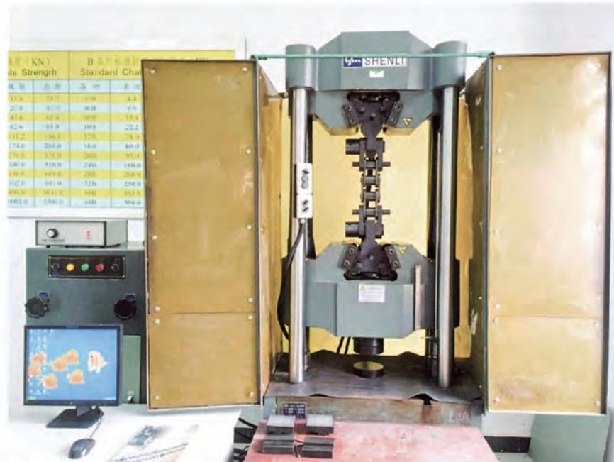
抗拉强度试验 Tensile strength tester
