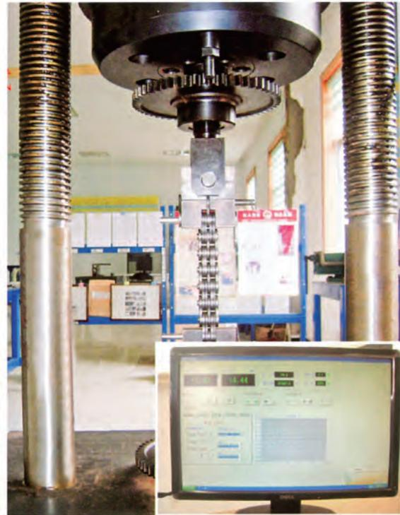
链条同步磨损试验机 Abrasion tester
